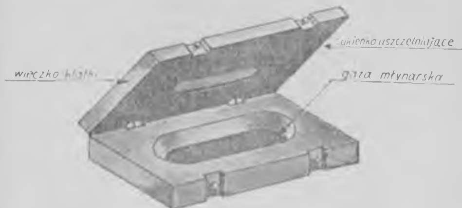
Ryc 1. Typowa klatka na wszy wg Weigla
